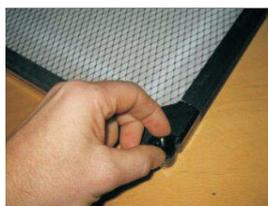
2. Öffnen des Filters durch Hochziehen der Clipverschlüsse.
